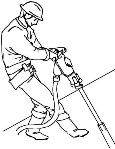
アンカー角度は法面に対して約 90° で削孔を行う。
